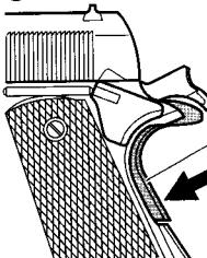
このセフティは、常時自動的にかかるので、グリップをしっかりと握る(銃口方向に押し込む)事で解除され、トリガーが引けるようになります。
