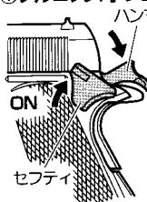
左図のハンマーが「フルコック」位置の時のみ、セフティを操作して、ONの状態に出来ます。また、この状態ではトリガーとスライドが操作できません。破損の原因となりますので、無理に動かさないでください。
