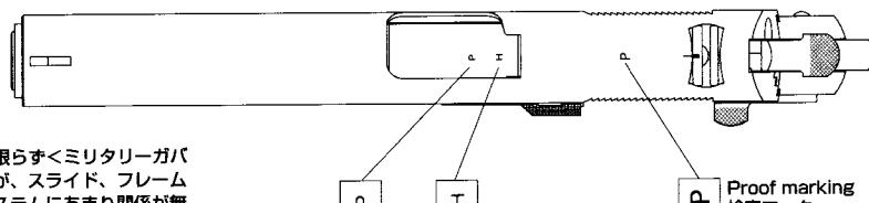
1943年製造のガバメントに限らずミリタリーガバメント>全般にも言える事だが、スライド、フレーム各パーツの外観はゲージ・システムにあまり関係がない「細かい部分」は、かなり個体差が存在している。特にトリガーガードの付根、マガジンキャッチ周りの「微妙なアールカット」などかなり違いが確認できる。当時、まだ手加工による細かな仕上げが為されていたのでこの様な個体差が生まれたものと推測される。
