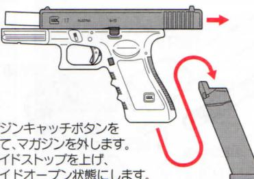
①マガジンキャッチボタンを押して、マガジンを外します。
