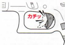
図のようにトリガーが後退したままロックされた場合、内蔵式ローラーハンマーはハンマーダウンの状態になっています。マガジンのセット(P55)を行い、初弾を送弾する事で、フルコックになると同時にトリガー位置が通常の位置に戻り、BB弾の発射が可能になります。
