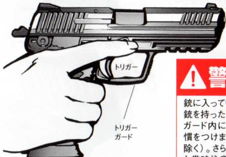
トリガーフィンガー（引金を引く指）をトリガーガードの外へ出しておく
