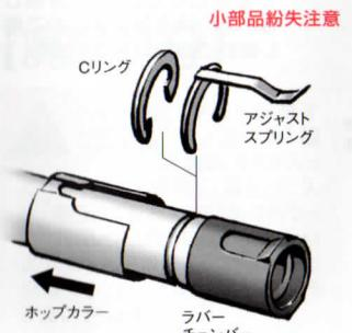
精密ドライバー等を使用し、アジャストスプリング-Cリングの順に外します。スプリングを变形させないように注意してください。ホップカラーをすらせば、ラバーチェンバーを外すことができます。
