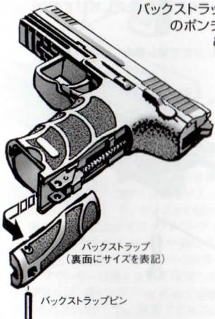
バックストラップを固定しているピンを直径3ミリのポンチを使用して抜きます。(割ピンのため、釘などで代用すると破損します)
