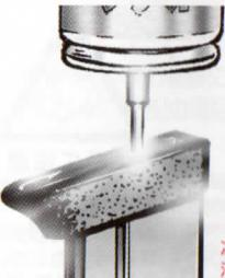
3.正常な注入後、満タンになったら液状ガスがふきだしますので注入を終了してください。しばらく放置しマガジンが常温(触ってみて熱さや冷たさを感じない程度)に戻ってから使用します。(マガジンが冷えていると正常に作動しません。)
