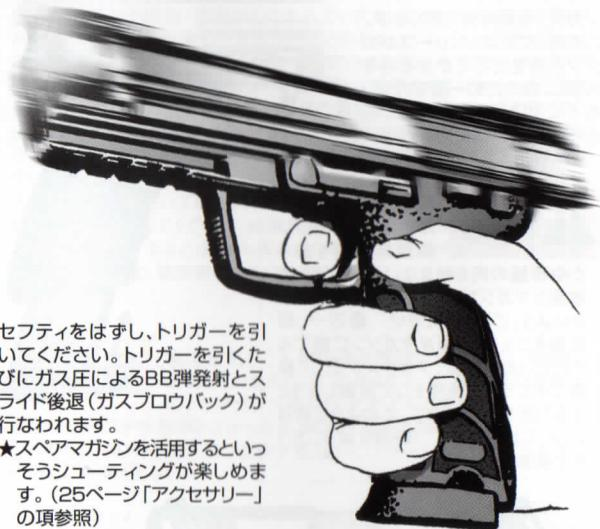
セフティをはずし、トリガーを引いてください。トリガーを引くたびにガス圧によるBB弾発射とスライド後退(ガスプロウバック)が行なわれます。
