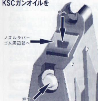
放出バルブを押した状態で、ノズルラバーの放出口からマガジン内部へKSCガンオイルを注入してください。また、ノズルラバー上面部や、放出バルブへも注油してください。
