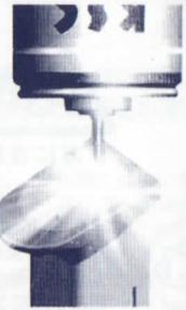
3.正常な注入後、満タンになったら液状ガスがふきだしますので注入を終了してください。しばらく放置しマガジンが常温(触ってみて熱さや冷たさを感じない程度)に戻ってから使用します。(マガジンが冷えていると正常に作動しません。)
