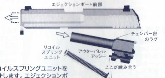
リコイルスプリングユニットをはずします。エジェクションポート前部と、アウターバレルのチェンバー部のラグが噛み合っていないようにし、そのうえでバレルを少し前にすらしてピストンとの連係をはずし、斜め下後方に抜いてください。
