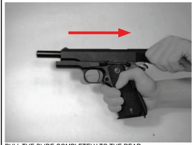
PULL THE SLIDE COMPLETELY TO THE REAR.
