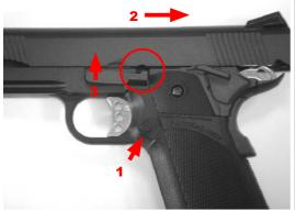
PRESS MAGAZINE CATCH AND REMOVE MAGAZINE.MOVE THE SLIDE REAR UNTIL THE TAKEDOWN NOTCH IS JUST ABOVE THE SLIDE STOP TAB AND REMOVE SLIDE STOP
