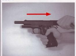
PULL THE SLIDE COMPLETELY TO THE REAR.
