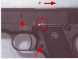
PRESS MAGAZINE CATCH AND REMOVE MAGAZINE.MOVE THE SLIDE REAR UNTIL THE TAKEDOWN NOTCH IS JUST ABOVE THE SLIDE STOP TAB AND REMOVE SLIDE STOP
