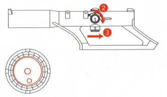
★歸零時請調整中間螺絲(紅色部份) 請勿旋轉外部固定座(黑色部份)。 Please adjust the middle knob (red color part), do not rotate the external fixed base (black color part).
