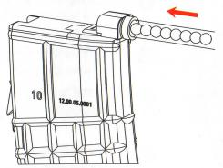
●禁止由上方填彈,請使用原廠 專用填彈頭。 Probibit reloading directly above
